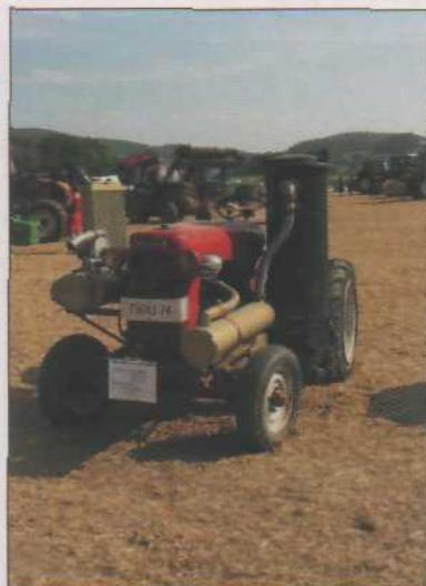
Рис. 9. Возрождение газогенераторных тракторов с газогенераторной установкой типа «Имберт» (Франция, 2004 г.)
