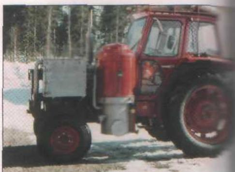
Рис. 7. Газогенераторный трактор с газогенераторной установкой типа «Имберт» (Швеция, 1976 г.)
