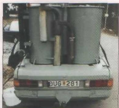
Рис. 6. Кустарная компоновка газогенератора на багажнике легкового автомобиля (США, 1975 г.)
