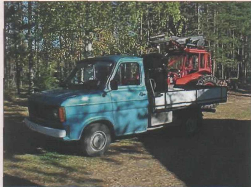
Рис. 8. Современный газогенераторный грузовой автомобиль (Франция, 2005 г.)
