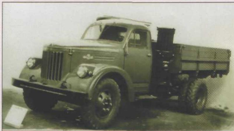
Рис. 1. Урал-ЗиС 354. Наиболее известный советский газогенераторный автомобиль
