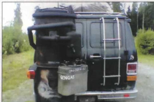
Современный автомобиль с кустарной газогенераторной установкой
