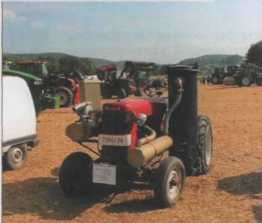
Современный газогенераторный трактор с газогенераторной установкой типа «Имберт» (Франция, 2004 год)
